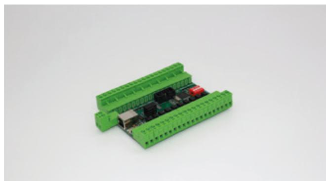
Platine GPIO avec port USB (10 entrées/sorties)
